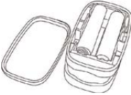
Figura 6. Instalación de las baterías
